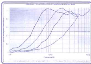
รูปที่ 2 แสดงความสามารถในการดูดซับเสียงของฉนวนยาง ArmaSound ที่ความหนาต่างๆ ตามมาตรฐาน DIN EN 20354 (ISO 354)
