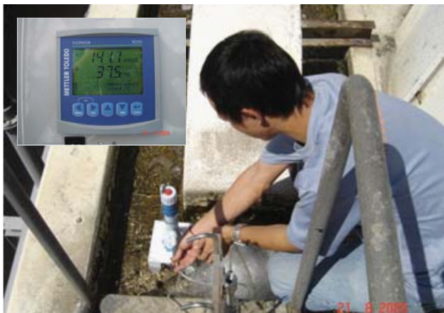
รูปที่ 10 แสดงการวัดค่า RESIDUAL DISSOLVED OZONE ด้านน้ำเข้า หอผึ่งเย็นพบว่าได้ค่า DISSOLVED OZONE 0.14 PPM และน้ำมีอุณหภูมิ 37.5C
