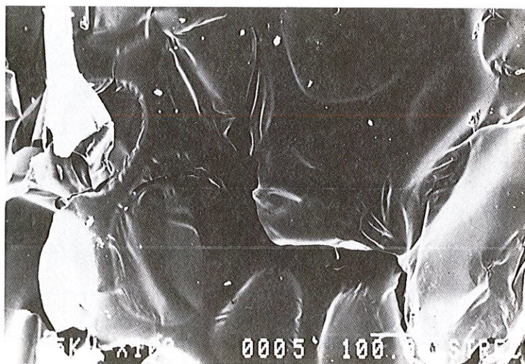
รูปที่ 10 ภาพขยายของฉนวนโพลียูรีเทนซึ่งจัดเป็นฉนวนเซลล์กึ่งปิด
